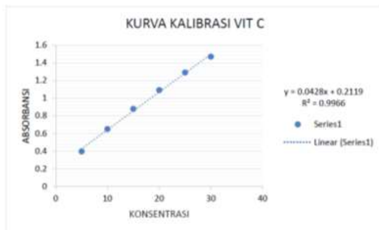
Gambar 1. Kurva Kalibrasi Standar Vitamin C Pada Panjang Gelombang 262 nm
