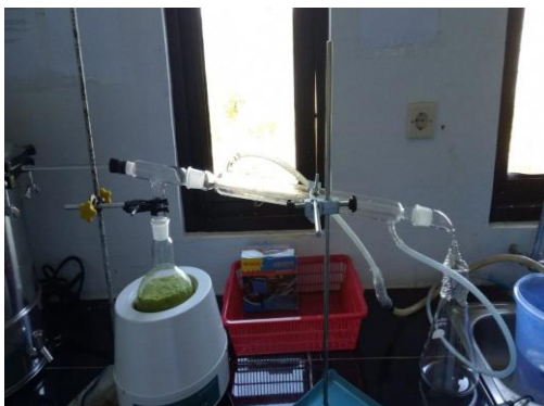
Gambar 1. Distilasi Sampel dengan Distilasi Uap Tipe Vakum
